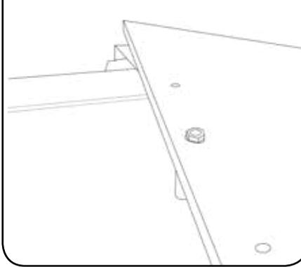
Schrauben Sie die selbstsichernde Mutter M6 (TEIL 4) auf die Zylinderschraube und ziehen Sie sie von Hand leicht fest.
