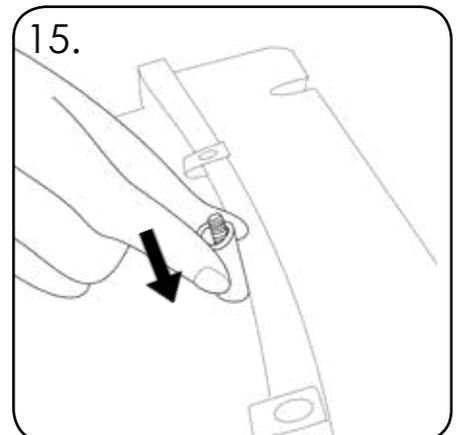
15. Legen Sie das Behältergehäuse auf eine weiche Oberfläche. Setzen Sie von der Außenseite des Behälters das Distanzstück (TEIL 2) auf die Zylinderschraube (TEIL 1).
