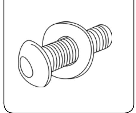
Bereiten Sie die Schrauben wie gezeigt vor, indem Sie die Unterlegscheibe M6 (TEIL 5) auf die Schraube M6 (TEIL 6) stecken.
