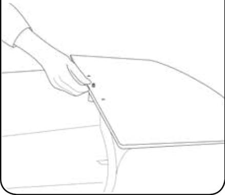
Setzen Sie das Schild (TEIL 3) auf die Zylinderschraube und achten Sie dabei darauf, dass die Grafikseite nach unten zeigt.
