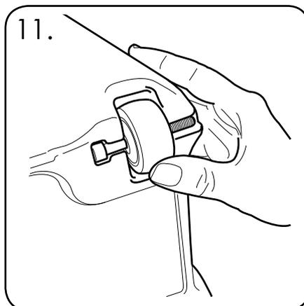
11. Bei umgedrehtem Behältergehäuse, klicken Sie das Rad mit der Schraube in den dafür vorgesehenen Schlitz. Wiederholen Sie dies mit dem zweiten Rad.
