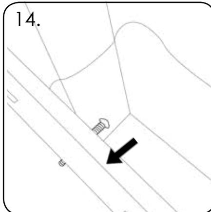
14. Fädeln Sie die Zylinderschraube (TEIL 1) von der Innenseite des Behältergehäuses durch den Behälter.
