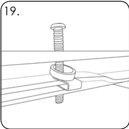
Platzieren Sie den Abstandshalter (TEIL 7) zwischen der Radmutter (TEIL 8) und dem Schild. Fädeln Sie die vorbereiteten Schrauben durch das Schild und ziehen Sie sie von Hand leicht fest.
